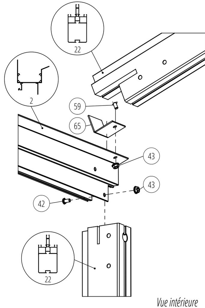
Fixation de la battée renforcée de toit sur la faîtière :
