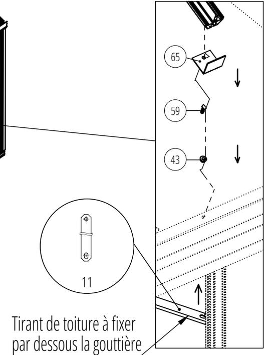
Tirant de toiture à fixer par dessous la gouttière
