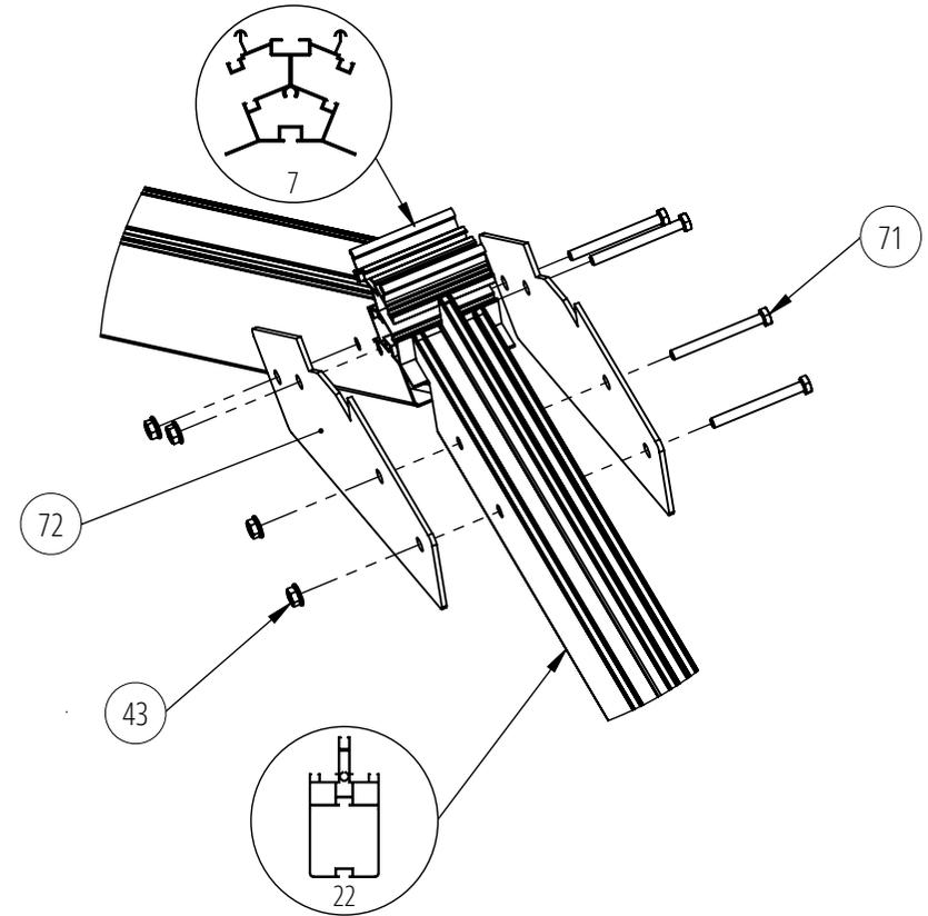
**Pour les serres de longueur 6,78 m**, veuillez utiliser la platine de jonction de faîtière (74) à la place de la platine (72) au niveau de la jonction de faîtière. Son entaille plus large permet de faire passer le U de jonction (75) qui relie les deux parties de la faîtière.
