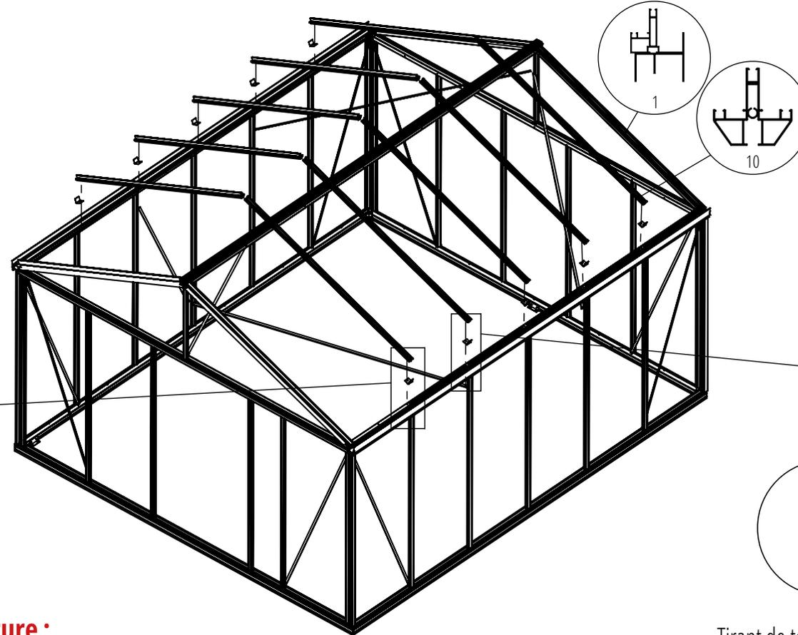
Vis M6x18 (59) au niveau des profilés avec tirant de toiture
