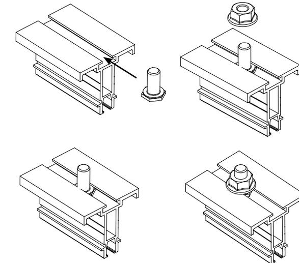
Il existe une fente à l'extrémité de la tête marteau. Le positionnement perpendiculaire au profil de cette fente (schéma **A**) vous assure que la tête de la vis marteau est correctement positionnée.
