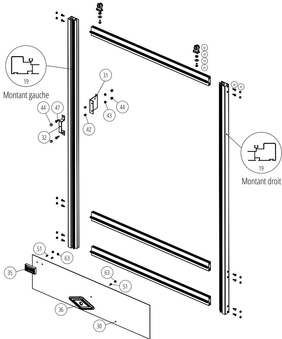
Il est important de positionner le **profil intermédiaire de bas** de porte de la façon suivante afin que celle-ci puisse bien coulisser dans le rail bas.
