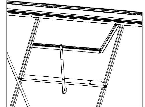
Lors de vents très forts, bien que la tirette soit en position fermée, celle-ci peut se déclipser et s'ouvrir (voir sortir de son logement de la faîtière). Aussi pour éviter ce désagrément, nous suggérons de maintenir la tirette en utilisant l'écrou (43) pour la fixer sur la vis (60).
