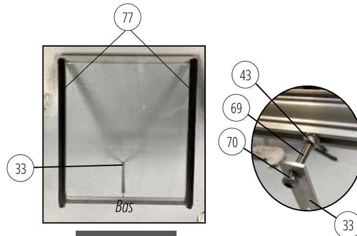
Centrer la vis M6x40 (69) sur le profilé (14) et la fixer avec un écrou à embase (43). Insérez la tirette puis positionner l'écrou frein (70).
