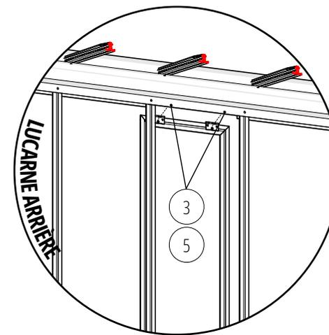
**3** Sous les lucarnes arrières, ainsi que les lucarnes avants avec un support de hauteur 40 cm et/ou une hauteur de faîtage de 3,10 m, une battée de sous lucarne (P) est à positionner comme ceci :
